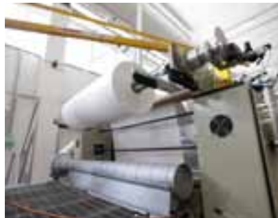
Laminering med PVC membran
